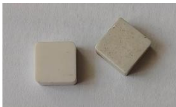
Фиг. 4. Сменяеми пластини от оксидна (бяла) минералокерамика [6]
