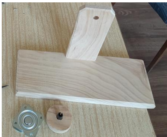
Фиг. 3а. Допълнителна стабилизираща стойка и лагерна система
