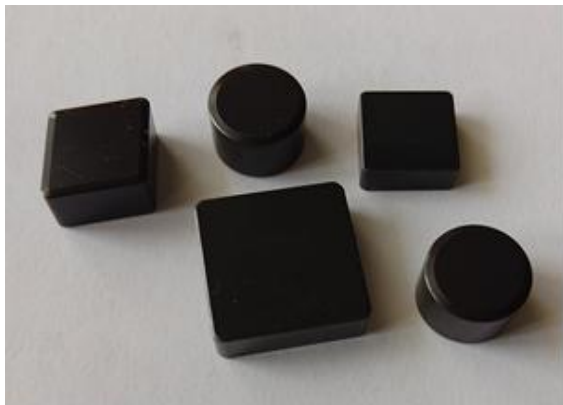
Фиг. 5. Сменяеми пластини от оксидно-карбидна (черна) минералокерамика [7]
