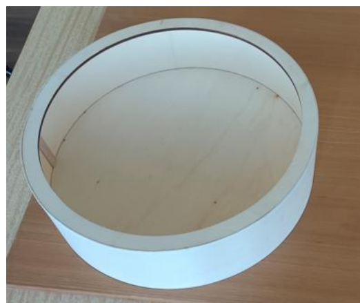
Фиг. 2. Основен корпус на измервателната система (цилиндър)
