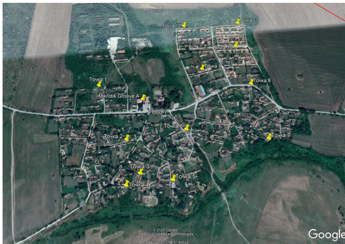
Фиг. 3.15. Контролни точки за мониторинг и изследване на безжичното радиопокрытие
