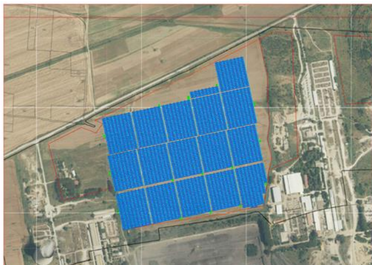
Фигура 4.23. Разположение на панелите на сайта и ТС на ФЕЦ в Битоля
