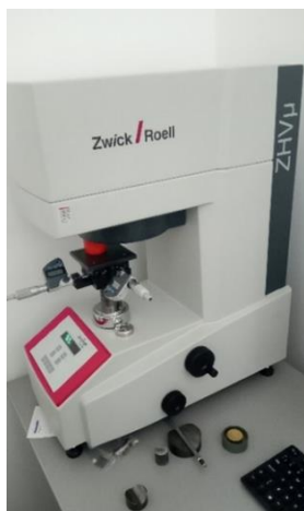
Фиг.4.9 Твърдомер Zwick/Roell- а); компютърна обработка на данни- б)
