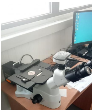
Фиг.4.8 Микроскоп с камера CMECH PRO 5 DC5000P
